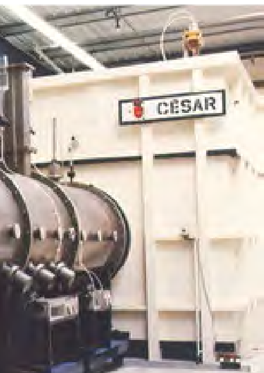
Figure 4 : César (situé sur le Centre CEA - Cesta) est une machine électrotechnique de haute puissance pulsée.
