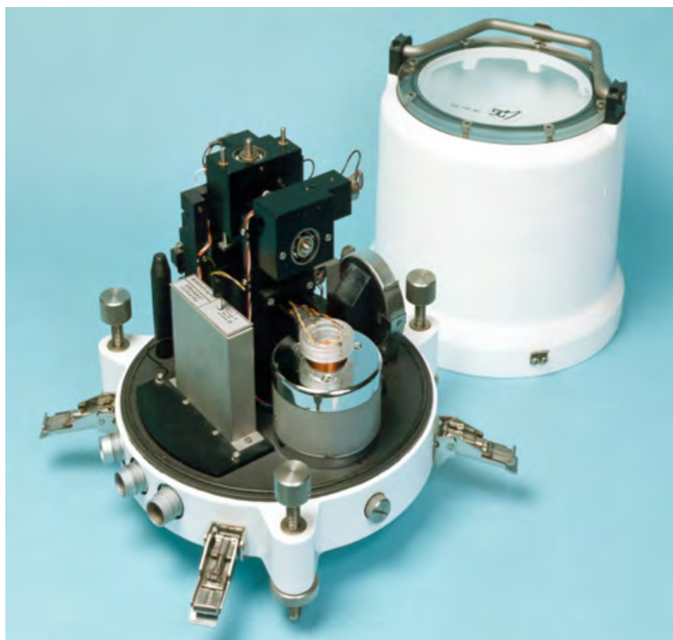
Figure 1 : Sismomètre « ZM500 », conçu à la DAM, qui équipe les sites de surveillance sismique du CEA en France.
