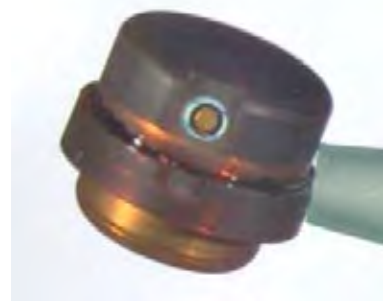
Figure 7 : Cible destinée à la réalisation sur le LMJ d'une expérience de fusion de deux isotopes de l'hydrogène (deutérium et tritium).
