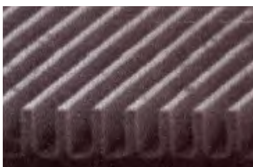
Figure 5 : Réseau de transmission gravé dans la silice.
