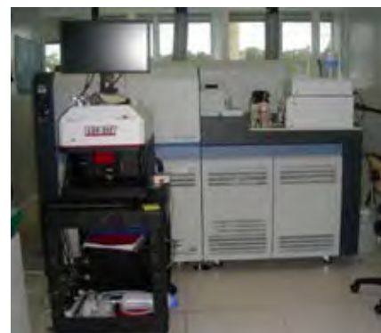
Figure 2 : Dispositif d'ablation laser (au premier plan) associé à un spectromètre de masse à source plasma (à l'arrière-plan) en salle propre ISO 7.
